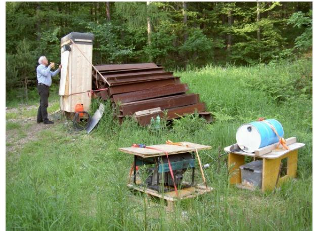
Zeichnung 1: LIDAR mit Umzäunung (links) und Stromversorgung mit Benzinaggregat (rechts).
