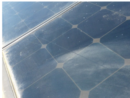
Bild 2: Modul mit beschädigter Oberflächenbeschichtung
